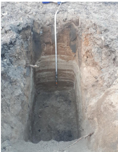
Detail výkopu ve fluviálních píscích
